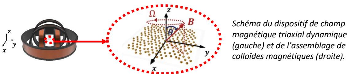
Schéma du dispositif de champ magnétique triaxial dynamique (gauche) et de l'assemblage de colloïdes magnétiques (droite).
